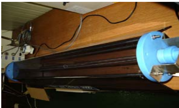
그림 5 파이렉스 유리 방전관 Fig. 5 Pyrex glass discharge tube
