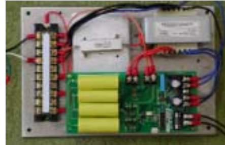
그림 16 고압 컨버터 Fig. 16 High voltage converter
