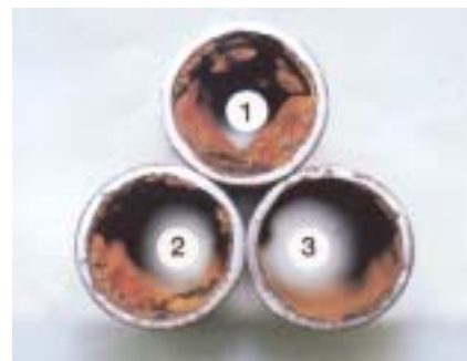
그림 18 전자장 수처리 시스템 성능 ①설치전 ②설치30일 ③설치60일 Fig. 18 The performance of the electromagnetic field water treater system ①before ②after 30 days ③after 60day
