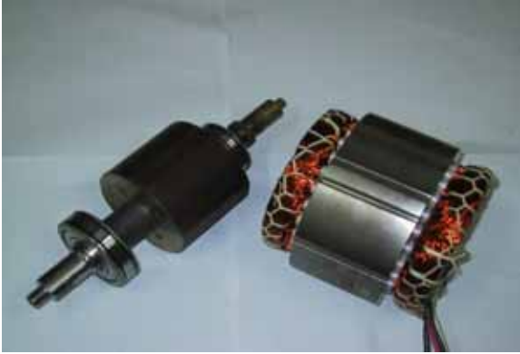
그림 10 실험용으로 제작된 동기릴럭턴스 전동기의 회전자와 고정자
