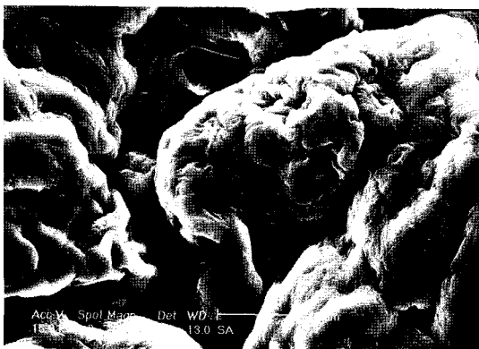
Fig. 6. SEM photo of MC-g-AA.
