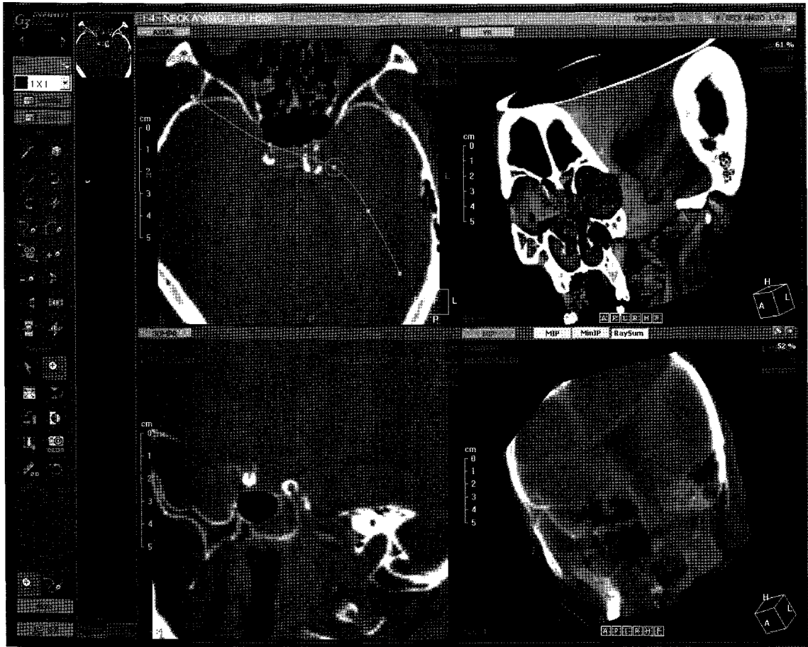
그림 6 여러 모듈의 동시 표현. 왼쪽 위의 MPR화면에 사용자가 곡선을 정의하면 왼쪽 아래에 곡선을 따르는 절단면의 단면 영상(곡면 MPR)이 생성된다. 또한 오른쪽에는 DVR(위)과 MIP(아래)가 서로 다른 관찰 파라미터로 영상을 출력하고 있다. 각 모듈은 독립적으로 기능함과 동시에 서로 파라미터를 전달하는 역할을 수행할 수 있다
