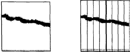
(a) 기울기 보정된 영상 (b) 균열의 폭 계산 그림 10. 기울기 보정을 이용한 균열 폭 계산 Fig. 10 Crack width computation for slope compensation
