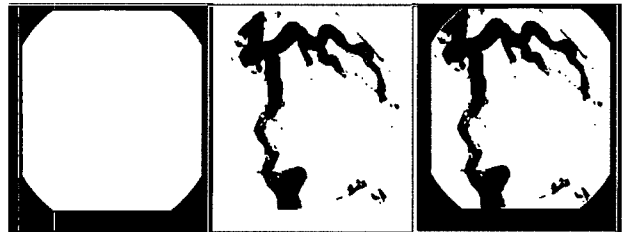
(a) 경계라인 검출 (b) 누적 제외템플릿 (c) 공통적인 배경 영역 (그림 6) 제외템플릿 누적 연산결과 최종 배경 영역
