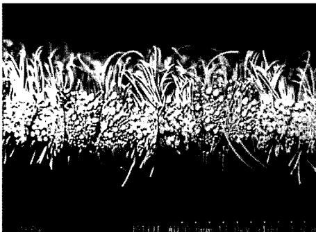
Figure 7. NI데이진소지의 리치테크 네오의 단면사진(폴리에스터/폴리프로필렌 복합직물).
