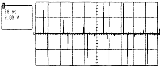
그림 9. 프리휠링 다이오드 전류 파형 Fig. 9. Freewheeling diode current waveform
