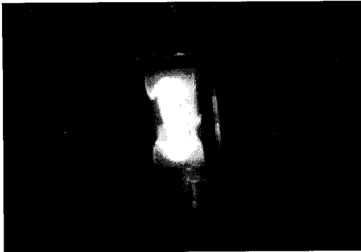
그림 18 음향공명으로 인한 불안정 불꽃 Fig. 18 Unstable lamp frame by AR
