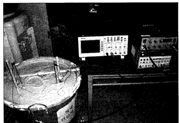
그림 17. 카올리나이트 슬러리의 강성 측정
