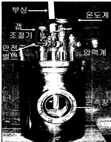
사진 1. 실험용 모의 GIS 챔버 Photo.1 The experimental model GIS chamber
