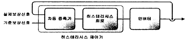
그림 14 보상전류 생성부의 구성도 Fig. 14 Block diagram of the compensating current generator.
