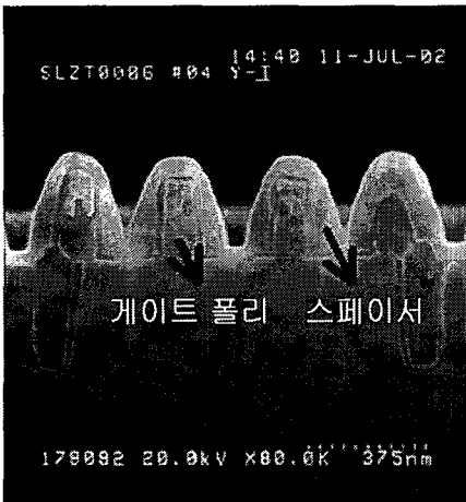
그림 3.3 측벽 스페이서 형성 후 SEM 분석사진
