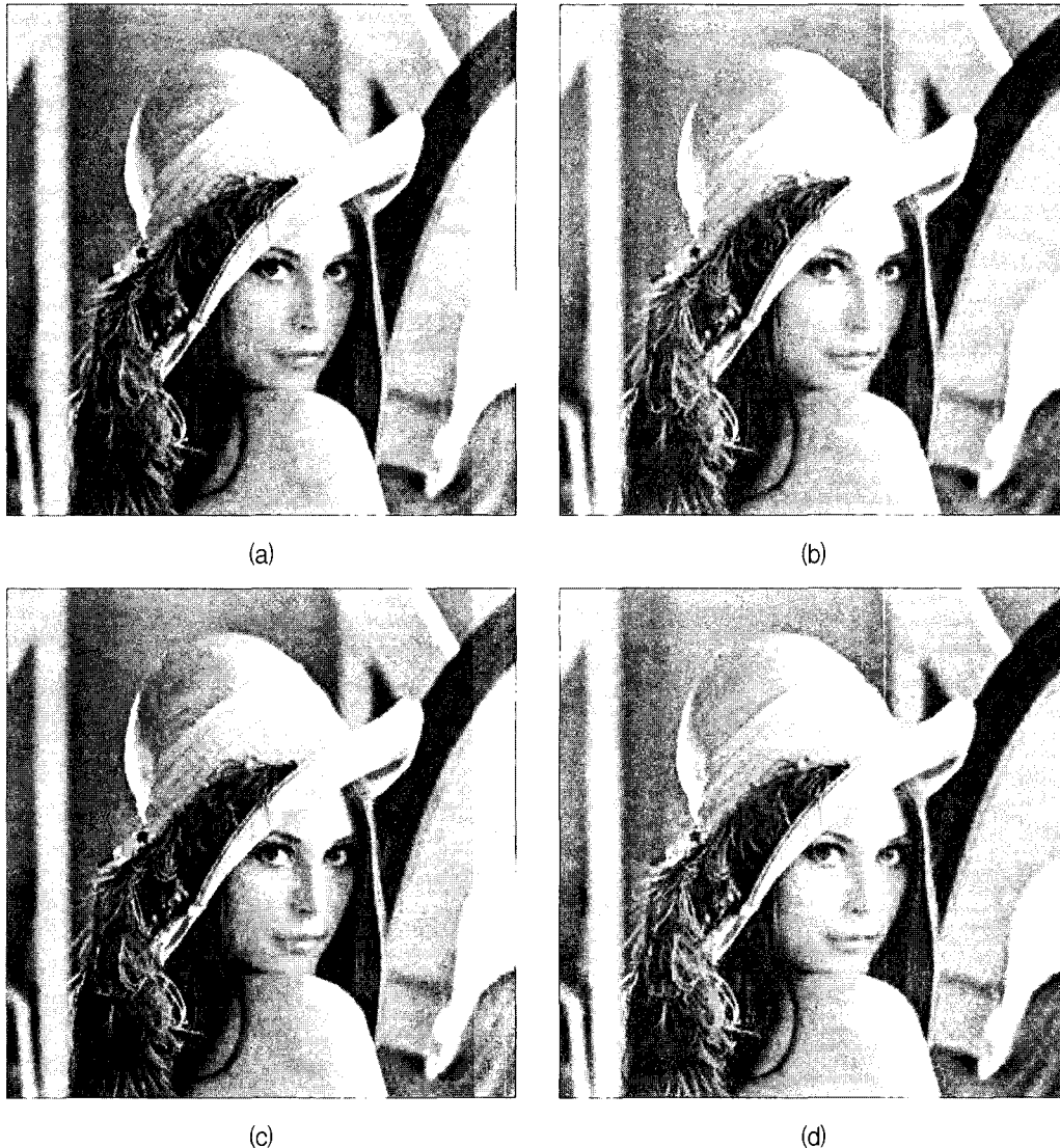
그림 3. \sigma_n = 20 일 때의 Lena 영상에 대한 기존 방법과 제안 방법의 잡음 제거 결과. (a) LAWML (30.65dB), (b) LAWMAP (30.90dB), (c) Bivariate (31.04dB), (d) 제안 방법 (31.35dB).
