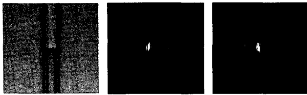
(a) core의 패턴 이미지 (200X) (b) 1.31 \mu\text{m} 파장대역의 근접장 패턴 (c) 1.55 \mu\text{m} 파장대역의 근접장 패턴 그림 5. 제작된 소자의 이미지와 근접장 패턴.
