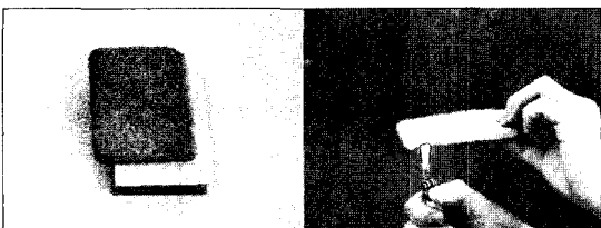
그림 12. 마이크로파를 이용하여 제조된 난연 PI 발포체.
