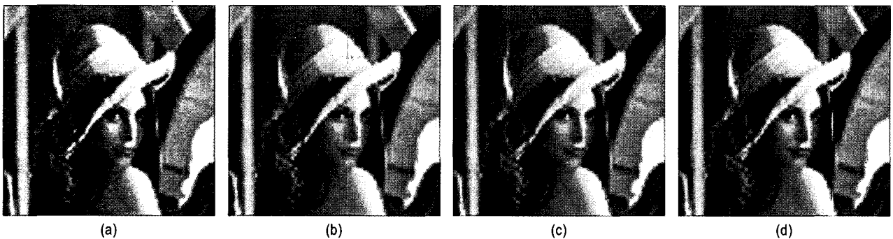
그림 6. 비적응적 정칙화 영상 보간 실험 결과 (a) 고정된 정칙화 매개변수 사용(PSNR=24.265), (b) 자동 정칙화 매개변수 사용(PSNR=24.262), (c) 고정된 정칙화 매개변수와 시각함수를 사용(PSNR=24.303), (d) 자동 정칙화 매개변수와 시각함수를 사용(PSNR=24.384) Fig. 6. The experiment result of spatially non-adaptive regularized image interpolation.
