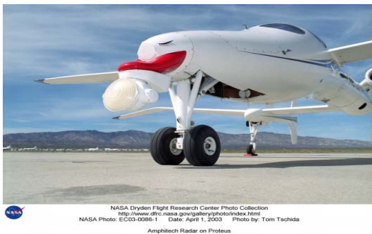
그림 5) Proteus 항공기에 장착된 충돌회피용 RADAR Sensor
