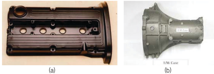
그림 6. 국내 독자기술로 개발한 마그네슘합금 자동차 부품: (a) cylinder head cover (b) transmission case.
