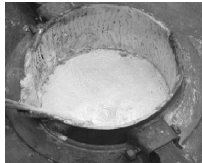
그림 1. HFC-134a를 보호가스로 사용한 경우의 마그네슘합금 용탕의 표면 상태
