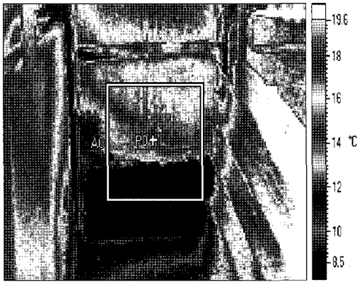
<사진 6> 문틈 사이로 찬공기 유입: 문틈 사이로 찬공기가 유입되어 축사내부의 온도가 떨어지는 것을 열화상 카메라로 촬영한 장면
