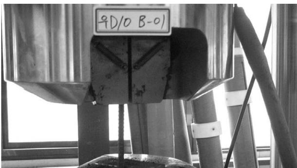
〈사진 4〉 UTM 장비로 철근의 인장강도 측정
