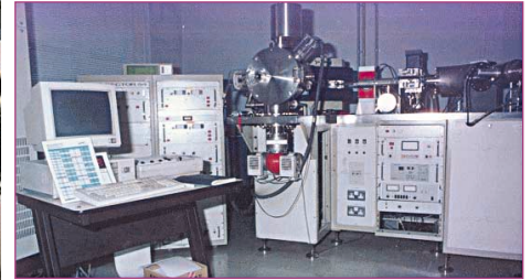
한국기초과학지원연구원 동위원소분석팀에 설치된 열이온화질량분석기 (VG54-30 모델)
