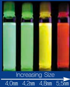
〈그림 8〉 CdSe 양자점의 입자 크기에 따른 UV광 여기 발광색의 변화
