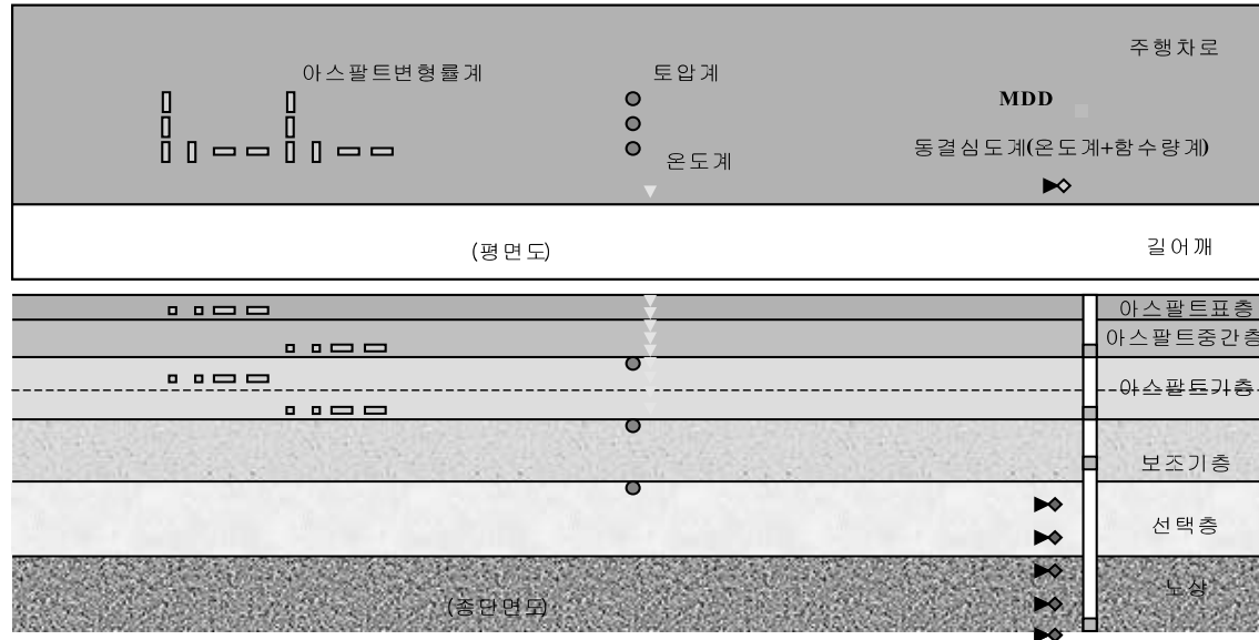
[그림 5] 아스팔트포장구간 계측기 설치 매설도
