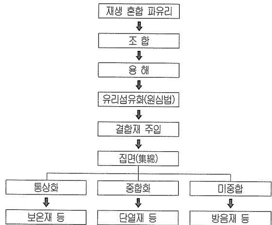
Fig. 1 일본 마그의 유리섬유 제조(원심법) 공정도
