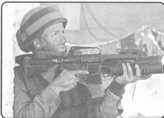
▲총열 아래 장착되는 표준 M203 40mm 수류탄 발사기는 수 발의 비살상용 탄을 사용할 수 있으며 사진에서 보는 바와 같이 개인 화기에 사용된다.
