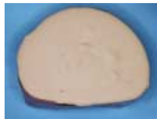
〈그림 12〉, 〈그림 12-1〉 Boxing한 후에 Fuji rock improved stone을 boxing체 내면에 주입한 상태
