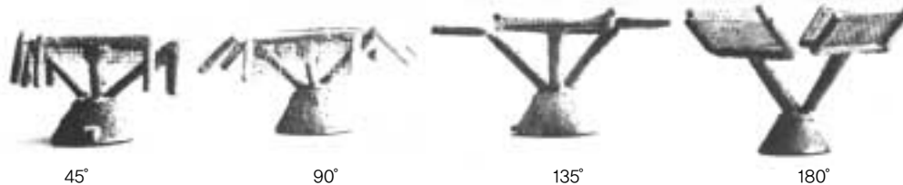
〈그림 2〉 Casting body for castability test
