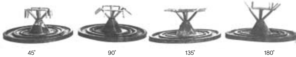
〈그림 1〉 Wax pattern for castability test
