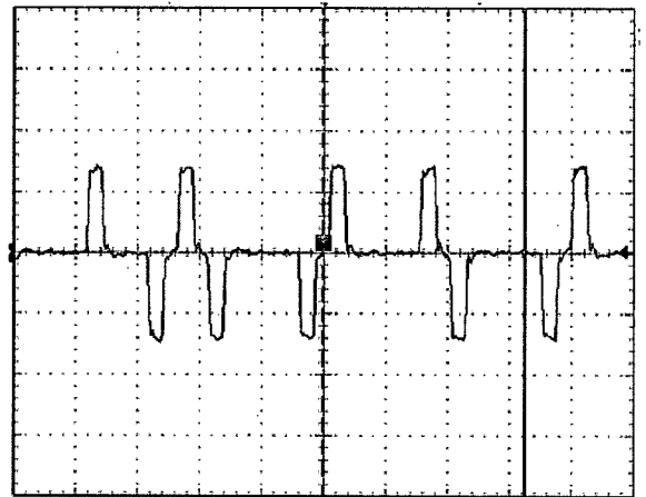
[그림 3] 노드간 통신에 있어서 전기적인 데이터 전송 신호(horizontal : 1\mu s , vertical : 1V)
