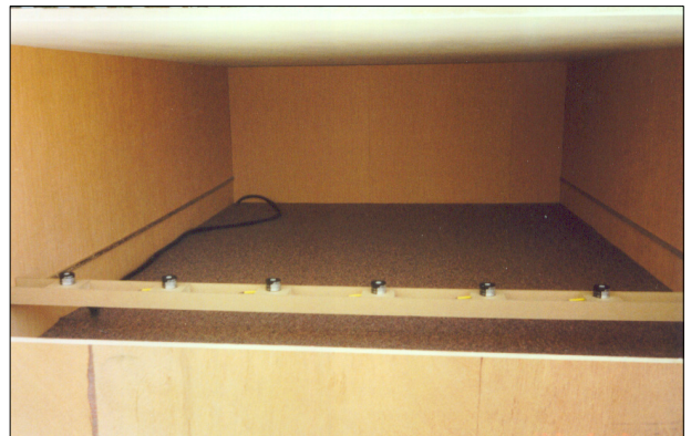
(a) 축소모형내부 조도측정레일 설치
