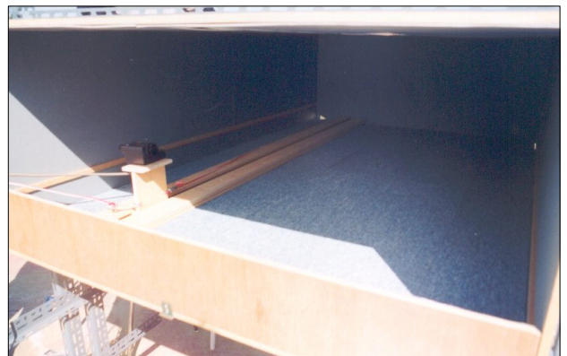
(b) 축소모형내부 휘도측정레일 설치
