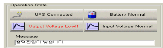
그림 4 저전압 경고 메시지 창 Fig. 4 Message display of under voltage operation state
