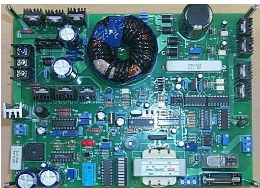
그림 6 컴퓨터 Power Supply 내장형 UPS의 실제 사진
