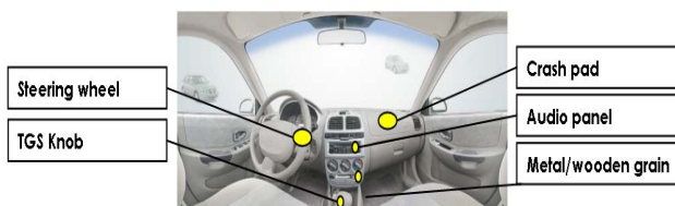
그림 1. 선정된 자동차 내장 재질 평가 부품.
