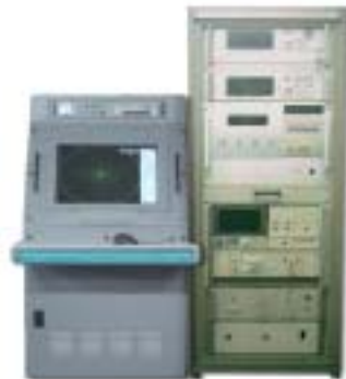
그림 2. 구현된 코히어런트 모노 펄스 레이더 시뮬레이터
