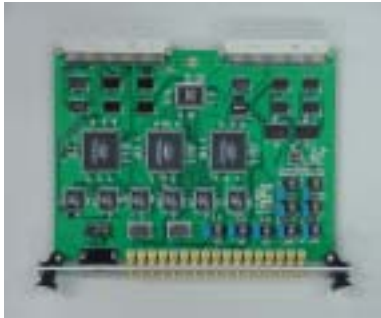
그림 4. VME BUS용 TSG보드 Fig 4. TSG board for VME bus
