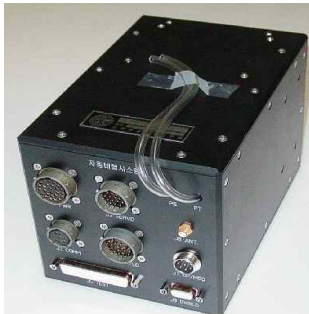
그림 5. 통합형 자동비행장치 외부 형상 Fig. 5. Integrated automatic flight control system external shape.
