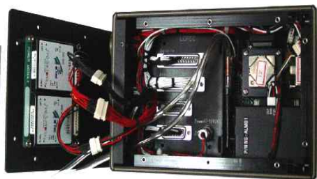
그림 6. 통합형 자동비행장치 내부 형상 Fig. 6. Integrated automatic flight control system internal shape.
