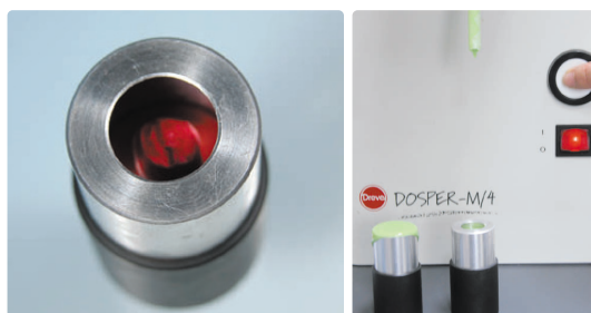
그림 7 복제용 몰드 내부에 실리콘을 주입하여 경화시킨다.
