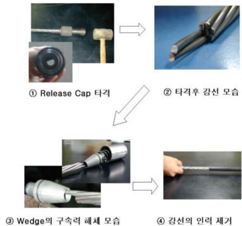
Fig. 7 SPEED 제거식 앵커의 제거 순서
