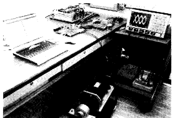
그림 12 정현파 엔코더를 이용한 고정도 위치측정을 위한 전체 실험장치 Fig. 12 Experimental set-up with an analog quadrature encoder for high precision position detection
