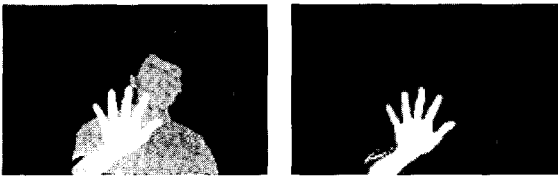
그림 8. 깊이 정보를 이용한 영역 추출. Fig. 8. Segmentation using depth information.
