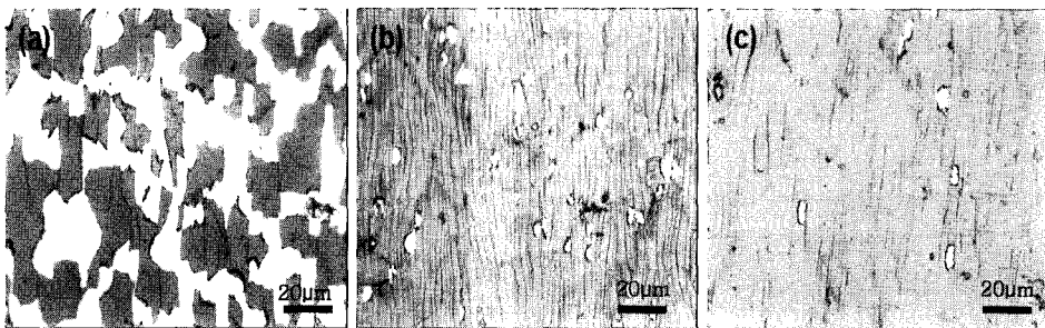
Fig. 5. 다양한 Ar sputtering 전처리 시간공정 (Bias voltage는 -600V로 고정)에 따른 10% 인장 변형시험후의 시편표면 미세구조 변화모습 (a) 15 min, (b) 30 min, 및 (c) 60 min.
