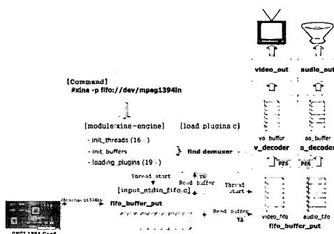
그림 6. Xine을 이용한 MPEG2-TS 데이터 재생
