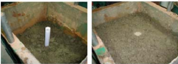
(a) 케이싱 설치
