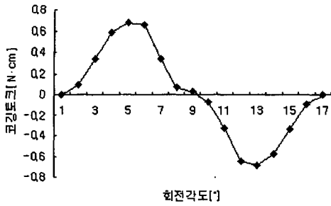
그림 3. 초기 모델의 코깅 토크 Fig. 3. Cogging torque for initial model
