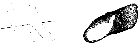
그림 5. 피 측정 발의 렌더링 데이터(좌)와 점군 데이터(우). Fig. 5. Rendering data(left) and the point cloud data(right) of the Measured Foot.
