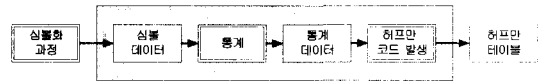
그림 5. 제안한 적응적 허프만 테이블 설계 방법 Fig 5. Design of adaptive Huffman tables in proposed algorithm
