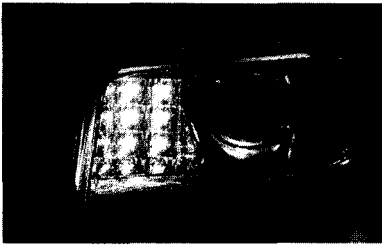
그림 8. head lamp 안에 daytime running light를 장착한 모듈
