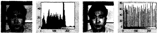
(a) 평활화 처리전 (b) 평활화 처리후 그림 3. 평활화 처리 전/후 영상과 히스토그램
