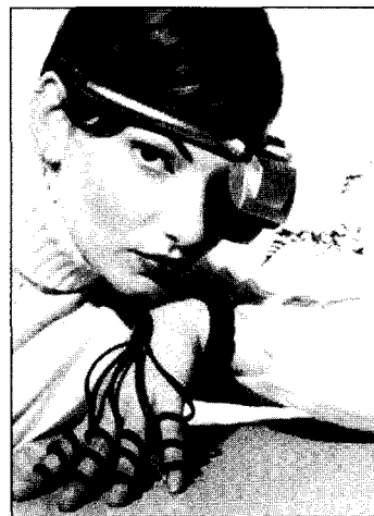
Figure 7. HMD와 동작감지 센서로 구성된 입는 컴퓨터.
