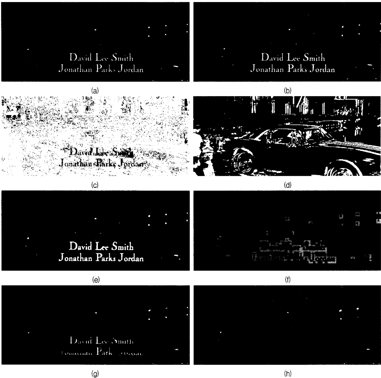
그림 9. 시공간적 복원의 결과: (a) 현재 프레임, (b) 이전 프레임, (c) 프레임 차이 영상, (d) 적응적 임계값을 적용한 프레임 차이 영상, (e) 겹쳐진 영역들, (f) 시간적으로 복원가능한 영역들, (g) 시간적 복원의 결과, (h) 시공간적 복원의 결과. Fig. 9. Spatiotemporal restoration results: (a) current frame, (b) previous frame, (c) frame difference image, (d) frame difference image after applying adaptive threshold technique, (e) occluded regions, (f) the temporally restorable regions, (g) result of temporal restoration, and (h) final result of spatiotemporal restoration.
